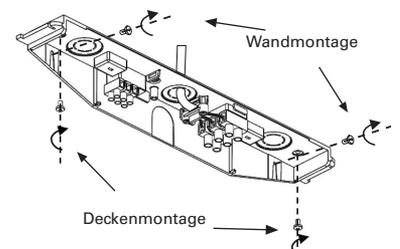
Bohren Sie wie angegeben und verwenden Sie Dübel und Schrauben, um die Montageplatte an der gewünschten Position zu befestigen.
