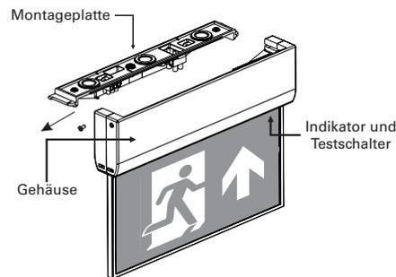
Entfernen Sie die Schrauben von beiden Seiten der Leuchte, um die Montageplatte von der Leuchte zu trennen.
