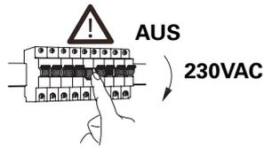
Stellen Sie sicher, dass die Spannungsversorgung abgeschaltet ist, bevor Sie die Notleuchte installieren.
